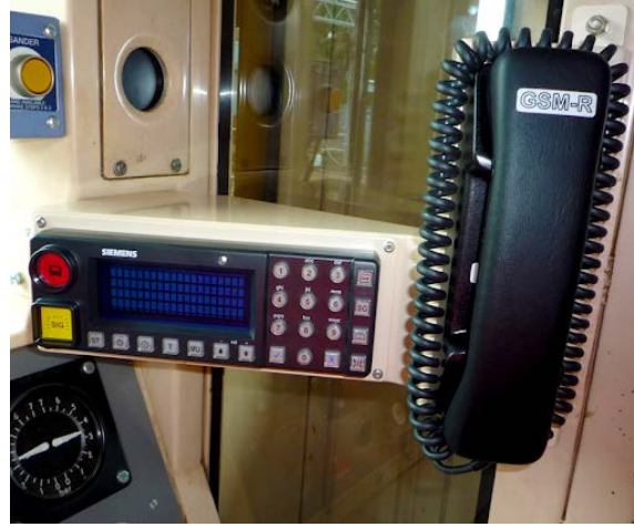
الشكل (٢٠) أجهزة الـ GSM-R مركبة في القاطرة.
