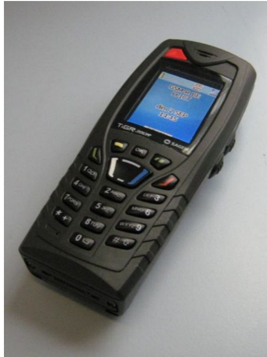
الشكل (١٩) هاتف GSM-R يستخدم من قبل الشركة الوطنية البلجيكية لسكك الحديدية
