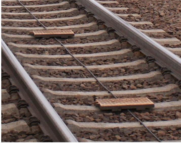
الشكل (١٧) توضع الـ Eurobalise بين قضبان السكة الحديدية
