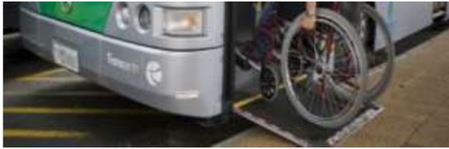
الشكل (١٠) : تزويد الحافلات برامبات تساعد على حركة الصعود والنزول لذوي الاحتياجات الخاصة.
