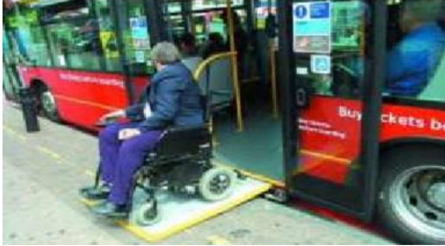
الشكل (١٣) : تزويد الحافلة بترامب لتسهيل حركة ذوي الاحتياجات الخاصة
