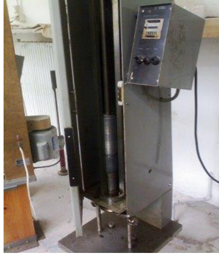
الشكل (٧-٣) قالب مارشال وجهاز رص العينات
