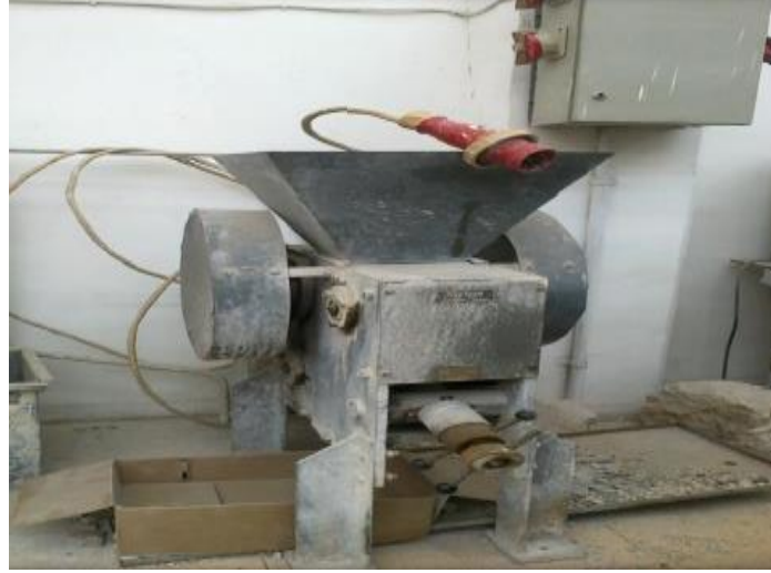
الشكل (٣-٤) الكسارة الآلية المستخدمة لتفتيت كتل البيتون
