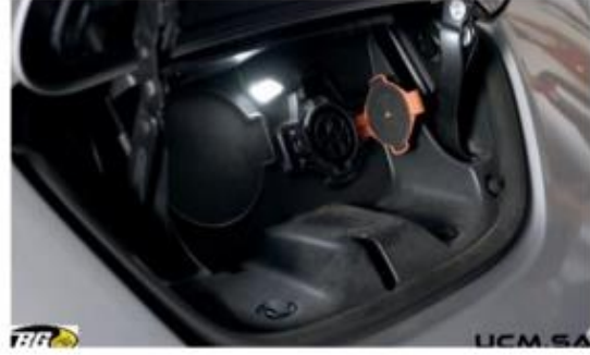
شكل (١٠) قابس شحن البطارية وموقعه في السيارة
