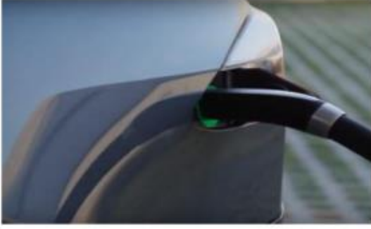
شكل (١٠) قابس شحن البطارية وموقعه في السيارة
