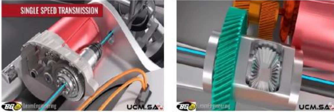
شكل (٧) يبين محول السرعات للسيارة وناقل الحركة إلى عجلة سيارات تسلا
