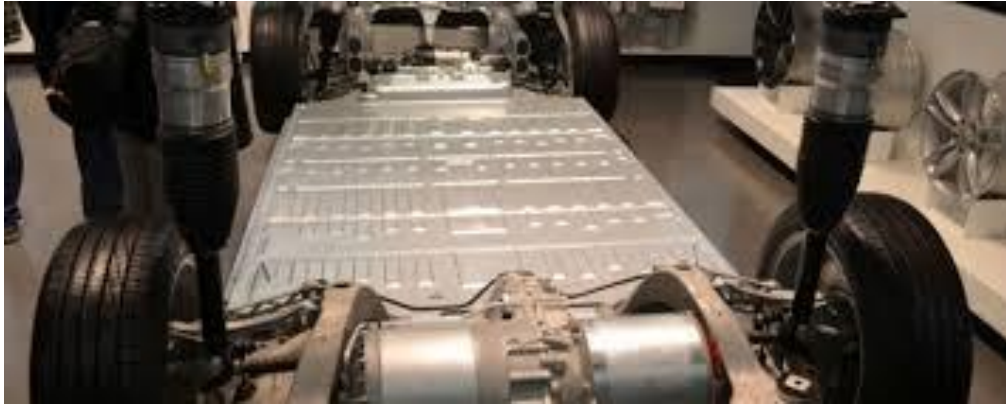
الشكل (٣) بطارية تسلا الموجودة أسفل كبينة السيارة
