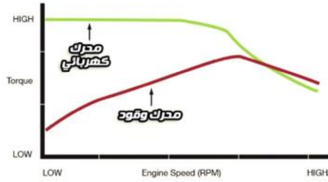
شكل (٨) مقارنة بين العزم وسرعة الدوران للسيارة الكهربائية وسيارات الاحتراق الداخلي
